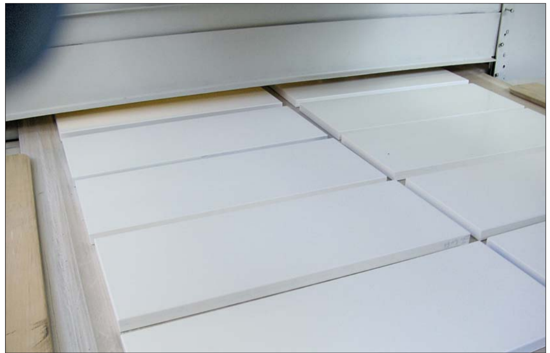
Abbildung 3 Lackierte Musterteile im Einlauf des HF-Streifelfeldtrockners
