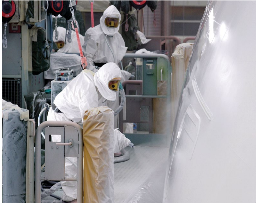
Rund 3150 m 2 Oberfläche beschichten die Airbus-Lackierer pro Flieger. Ungefähr 10 bis 14 Tage dauert es, bis ein frisch lackierter A380 die Halle wieder verlässt. Quelle: Airbus
